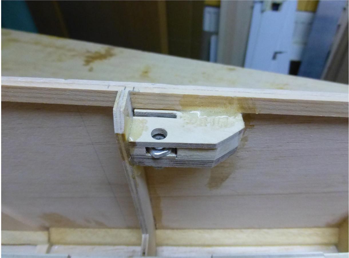
Da mir ein einfacher Kabinenhaubenverschluss für diese relativ große Haube zu unsicher war, habe ich links und rechts an der Rumpffinnenseite jeweils eine entsprechende selbstgestaltete Verriegelung eingeklebt.
