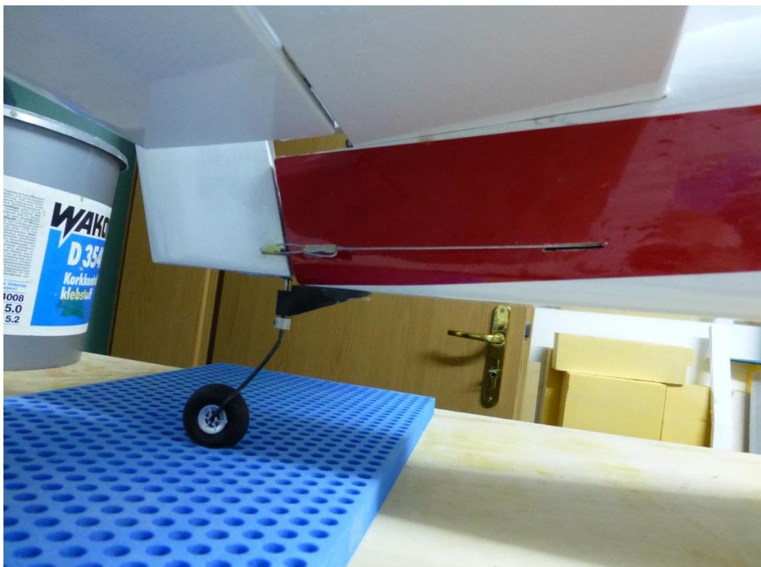
Zum Abschluss wurden noch die Kabinenscheiben eingeklebt, die Ruderanschlüsse für Höhen-und Seitenleitwerk hergestellt und die Anlage eingebaut.
